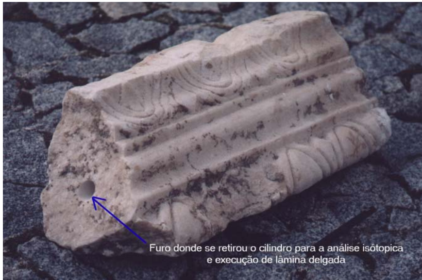
Fig. 6 - Fragmento de friso das termas romanas a partir do qual se fez a amostragem de mármore
