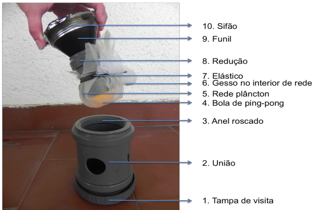
Figura 4: Ilustração das várias partes que constituem a “ cypris-trap ”: parte fixa à rocha (1., 2. e 3.) e parte amovível (4. a 10.), segundo Cruz et al. ,(2013).
