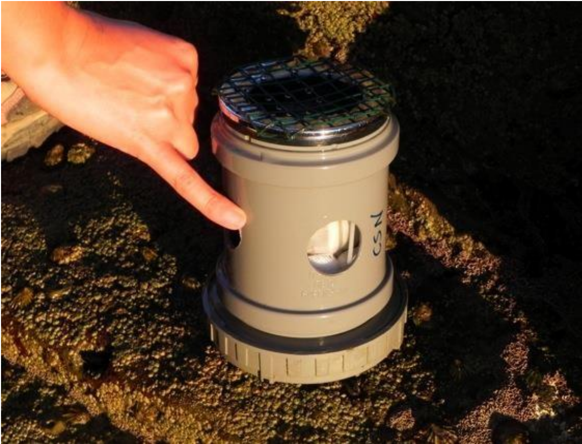
Figura 5: “ Cypris-trap ” fechada e colocada na zona intertidal, pronta a recolher as larvas cypris .
