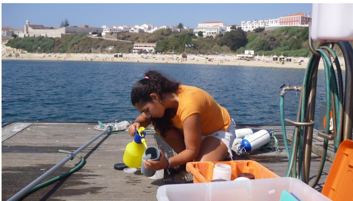
Figura 3B: Amostragem na Marina do Porto de Sines, lavagem do copo para recolha da amostra.
