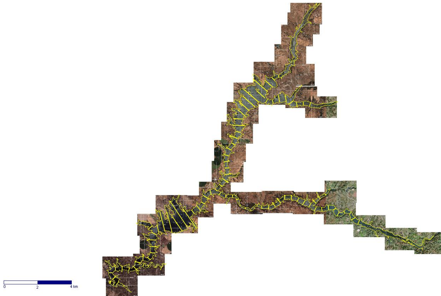
Figura D.1- Trilha de navegação com 92 transectos, correspondente a um coeficiente de cobertura (d) de 8,4.
