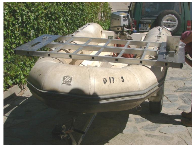
Figura C.6. Fixação dos dois segmentos da escada através das placas laterais
