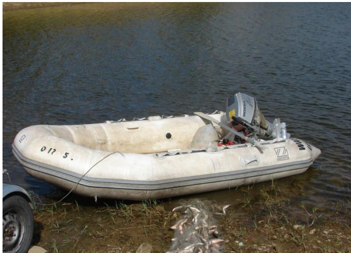
Figura C.4. Semi-rígido utilizado, um Zodiac de 3,7 m equipado com um motor Honda a 4 tempos com 5.5 CV.
