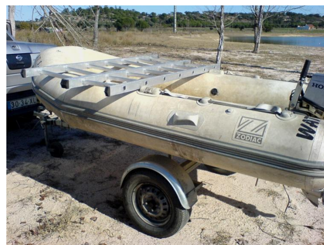
Figura C.5. Colocação dos dois segmentos da escada, justapostos.
