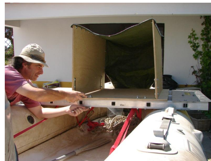
Figura C.10. Colocação da caixa de protecção sobre a placa central e fixação destas 2 estruturas ao conjunto já montado
