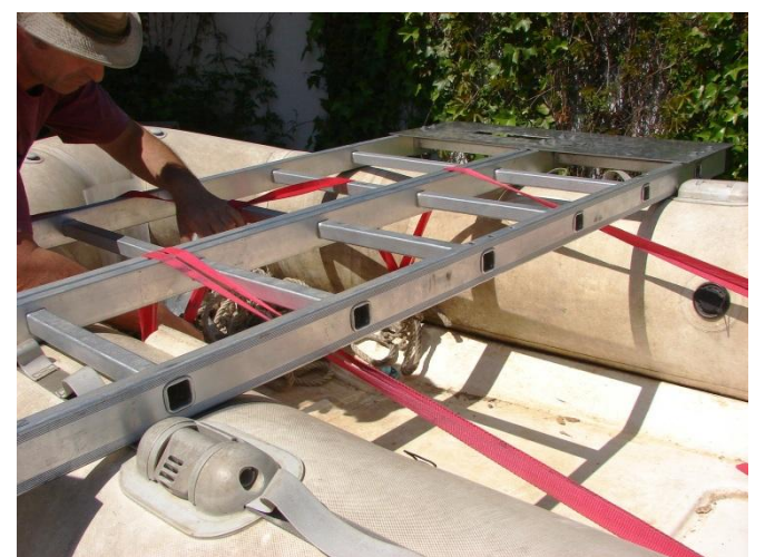
Figura C.7. Fixação do conjunto escadas/placas laterais ao semi-rígido através de 3 poleias
