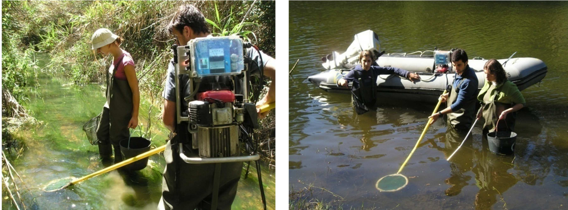
Figura 15- Aparelho de pesca eléctrica utilizado na captura de lampreias.
