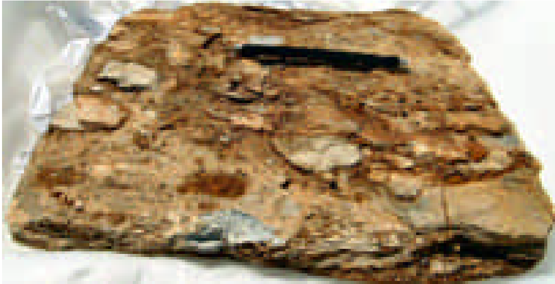
Fig. 2.26 – Aspecto geral do “calcário com crinóides” do anticlinal de Ferrarias, onde se destaca a natureza essencialmente detritica da rochas. Os fragmentos líticos correspondem, entre outros a dolomitos e a xistos e xistos bandados afins das formações de Fatuquedo e Terrugem. A matriz é essencialmente constituída por carbonatos onde por alteração diferencial, se destacam os crinóides. A proveniência destes fragmentos é um assunto que merece ser tratado com a devida atenção pois pode esclarecer muitas das dúvidas que ainda persistem no que concerne à génese desta rocha. Amostra solta recolhida no ponto A – Fig. 2.25.
