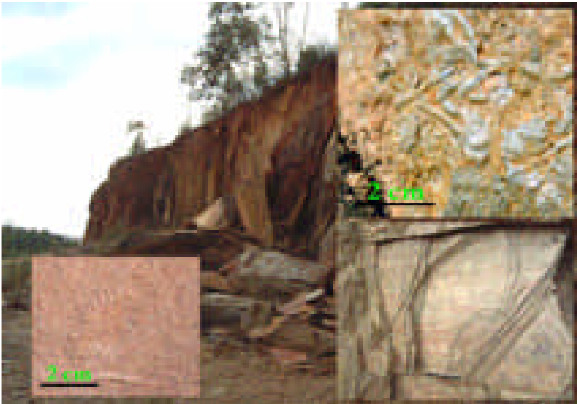
Fig. 1.12 – Pedreira do Mestre André – Barrancos. Piso superior à exploração principal onde se pode constatar que o xisto continua a ter interesse comercial. Em cima à direita e em baixo à esquerda podem-se observar dois pormenores das pistas presentes no xisto. Em baixo à esquerda, um dos aspectos texturais /estéticos que o xisto pode apresentar.
