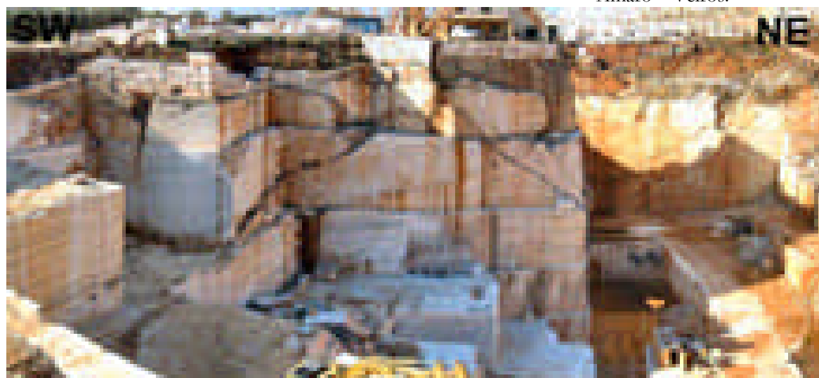
Fig. 1.3 (À esquerda) – Exemplo de composição fotográfica elaborada, neste caso, a partir de seis imagens individuais. São claramente distintos os critérios de cisalhamento esquerdos com topo para noroeste (não interpretados sobre a fotografia). Estrada S. Amaro – Veiros.
