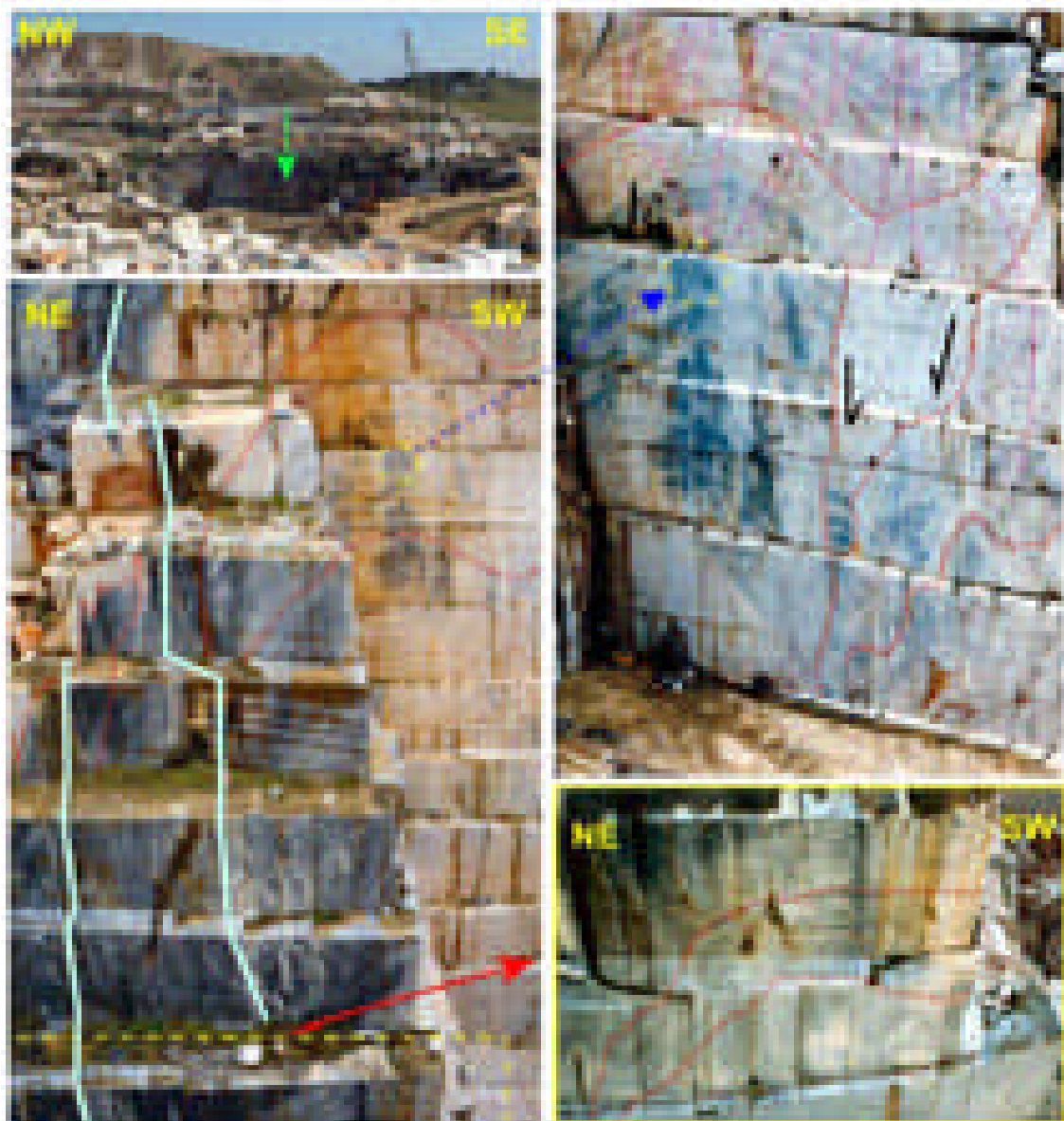
Fig. 2.42 – Vários aspectos da pedreira da empresa Marmetal – Fonte da Moura – Pardais. Em cima à esquerda – enquadramento da geográfico pedreira, atrás da elevação no horizonte situa-se a Mina de Miguel Vacas (Monte dos Vieiros). Em cima à direita – frente SE da pedreira onde se pode observar o modo como variam os mármore de diferentes tonalidades; também se observa o rejeito vertical numa das várias bandas de cisalhamento existentes na pedreira e ainda, a disposição em leque da clivagem de fractura associada ao dobramento de segunda fase. À esquerda em baixo – transição para os mármore mais escuros (variedades Ruivina), os traços verticais correspondem a planos de concentração da deformação (bandas de cisalhamento) e também apresentam concentração em carbono. Em baixo à direita pormenor que realça o modo como a variação lateral na cor do mármore não é acompanhado por interrupção da estratificação.
