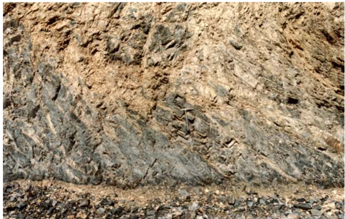
Fig. 5.19 – Pormenor do perfil de alteração de um maciço rochoso do FBA, evidenciando a influência da estrutura na meteorização destes maciços.
