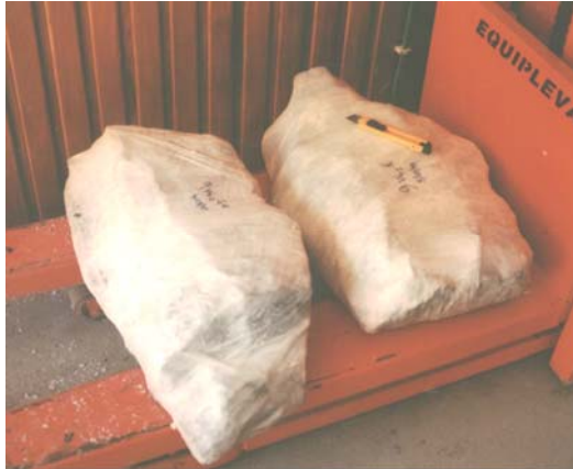
Fig.4.5 – Amostragem de superfície. Aspecto dos blocos de rocha parafinados.
