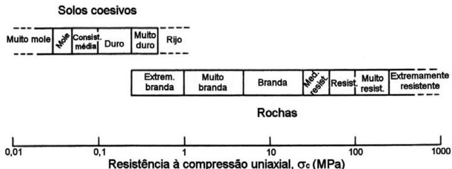
Fig. 1.2 – Definição de rocha branda de acordo com a classificação da ISRM, 1978 (adaptado de Hencher, 1993).
