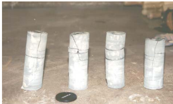
Fig.4.6 – Aspecto dos provetes extraídos dos blocos de rocha parafinados.
