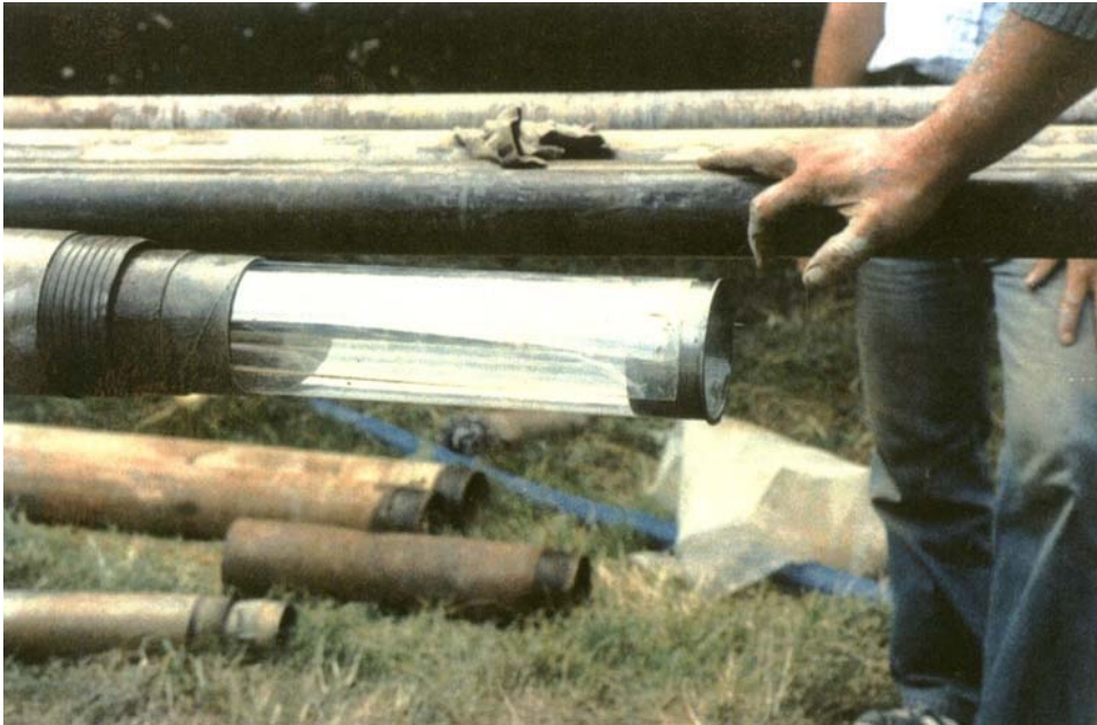
Fig. 2.4 – Pormenor do revestimento interior em plástico (“ liner ”), num amostrador de parede dupla (extraído de Dobereiner, 1984).
