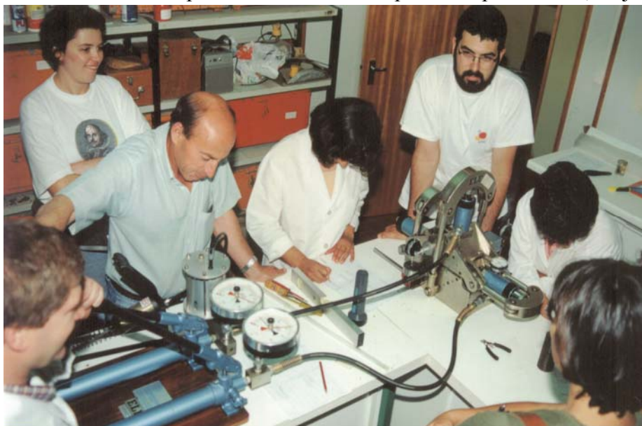
Fig. 4.14 – Máquina de Hoek durante um ensaio de deslizamento de diaclases.
