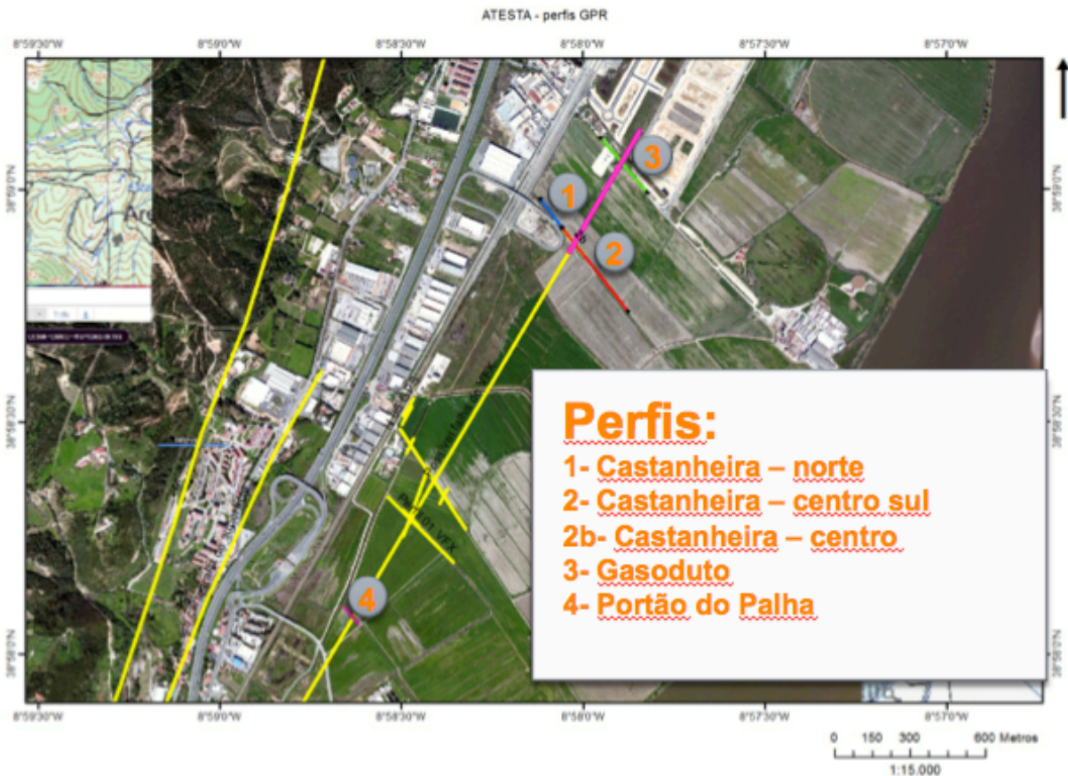
Figura 2 –Zona de implantação dos perfis de Sísmica, Georadar (GPR) e Elétrica na zona de Castanheira do Ribatejo. São perfis na proximidade da falha de V. F. de Xira cuja localização provável está indicada a amarelo.
